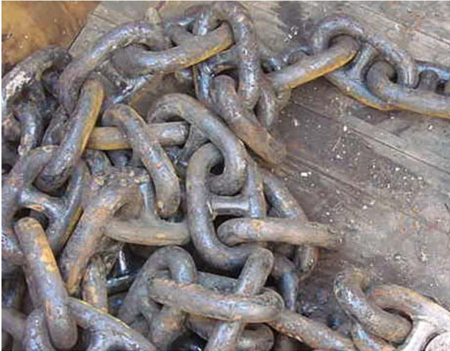
Foto No 02. Tramo de cadena eslabonada de 90 pies con concrete de 1 ¼" con end link y edlarged link en acero al carbón calidad U2.
