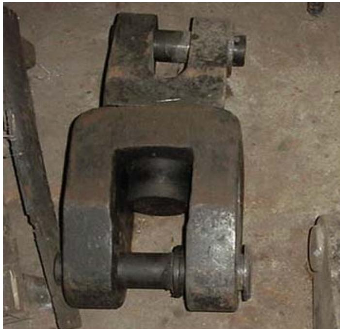
Foto No 01. Grillete giratorio tipo quijada doble perno con pin de 1 ¼" equivalente a giratorio mordaza y mordaza de 1 ¼".
