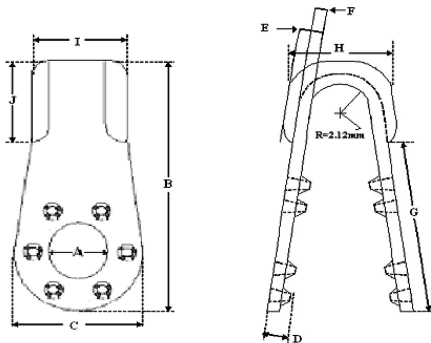
**NOTA 1:** El radio interno de la vuelta tiene una tolerancia de mas o menos 0.2 mm
