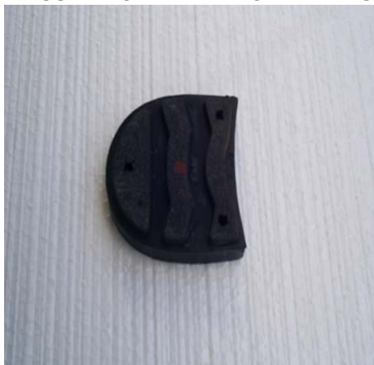
FIGURA No. 1 VISTA SUPERIOR DEL TACÓN DE CAUCHO PARA BOTA.
