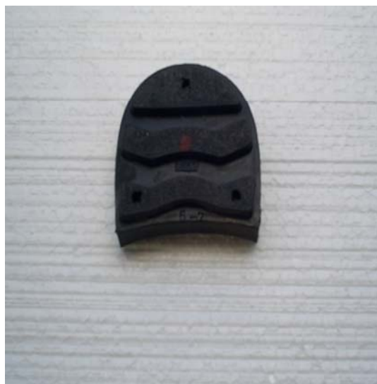
FIGURA No. 1 VISTA SUPERIOR DEL TACÓN DE CAUCHO PARA BOTA.
