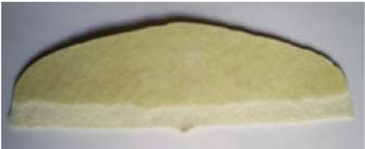
FIGURA N° 2. LÁMINA TERMOADHESIVA DE 1.8 PARA CONTRAFUERTE
