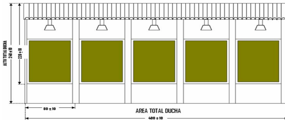
FIGURA N° 2 DIMENSIONES GENERALES DUCHAS DE CAMPAÑA VISTA TRANSVERSAL SECTOR DERECHO
